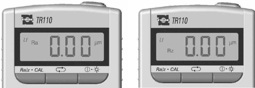
Bild 5: Ra/Rz-Einstellung (Ra links oder Rz rechts)
