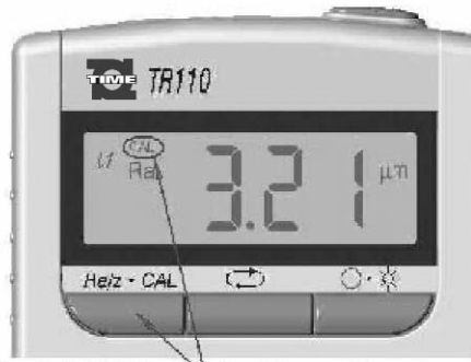
Bild 9: Wechsel in den kalibriermode durch Drücken der linken Taste für 2 Sekunden
