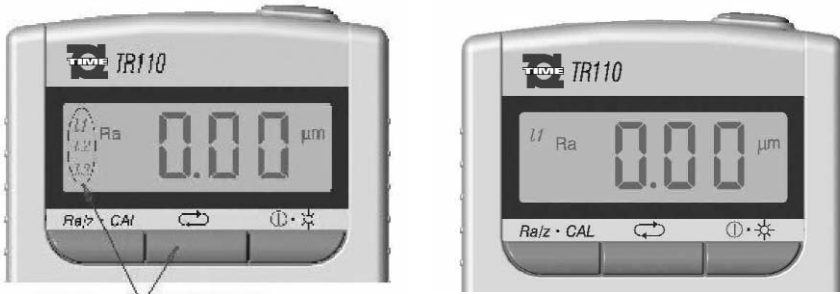
Bild 6: Einstellung der Grenzwellenlänge (rechts auf L1 = 0,25 mm)
