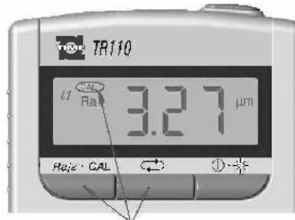
Bild 10: Verändert des Messwertes durch Drücken der linken oder mittleren Taste
