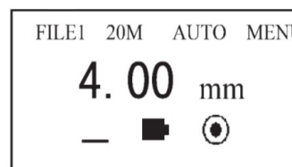
Abbildung 12 Nach Entfernung des Prüfkopfs
